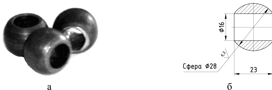
Рис. 1. Общий вид (а) и конструкция (б) шаровых втулок, полученных при экспериментальном исследовании процесса поперечной прокатки осесимметричных изделий сложной формы
